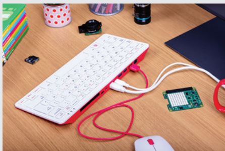
رزبری پای ۴۰۰ یک سیستم کامپیوتری درخود است که درون یک صفحه‌کلید جاسازی شده است.
